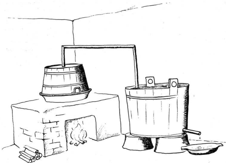
6. Kisüsti pálinkafőző készség rekonstrukciós rajza. Készítette: Szűcs Árpád.
