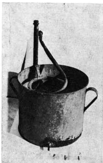
4. Hűtőfázék spirális páracsővel Fá: 50 cm, m: 32 cm. Lelt. sz.: 73. 11. 1. 4. (MFM)
