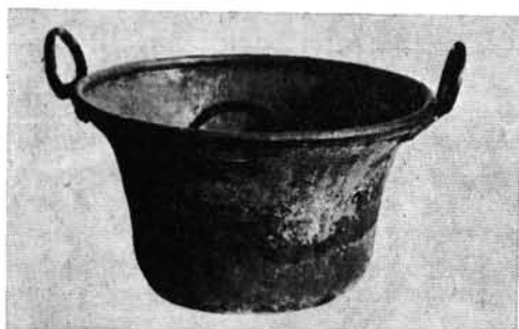
3. A kisüsti pálinkafőzésnél használt rézüst. M[agassága]: 40 cm, f[első] á[tmérője]: 60 cm. Lelt. sz.: 72. 5. 1. (MFM)
